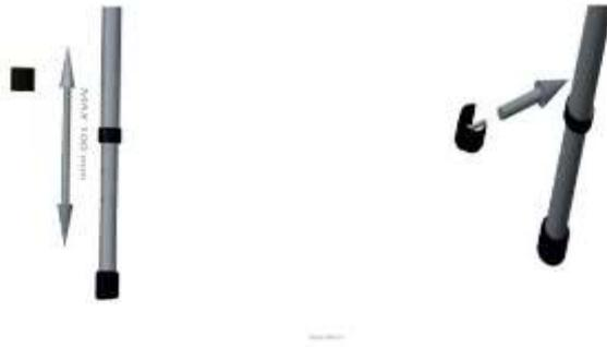
Vor dem ersten Gebrauch muss die Höhe des Produkts eingestellt werden. Dazu ist der Einsteckclip herauszunehmen, die gleiche Höhe für alle vier Beine einzustellen und anschließend der Clip in entsprechende Bohrung einzustecken. VERGEWISSEN SIE SICH, DASS DER STAHLBOLZEN DURCH DIE BOHRUNG IN DEN BEIDEN SEITENWÄNDEN STECKT. Anderenfalls kann das Produkt instabil sein und die Bohrung verformt werden
