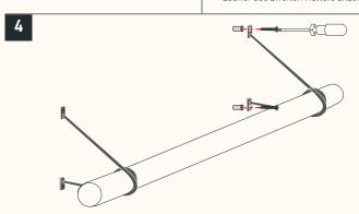
• Löcher des zweiten Halters bohren und Schrauben anziehen
