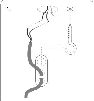
Aufgrund der Konstruktion ist der Anschluß einer Erdung (des Erdungsleiters) nicht notwendig. Die Leuchte kann verpolungssicher angeschlossen werden.
