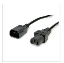
Kabel mit Kaltgerätestecker IEC320 C14 und Warmgerätebuchse IEC320 C15. Der Steckverbinder-Typ C14/C15 ist speziell für Geräte mit höheren Temperaturen ausgelegt, wird aber auch als Sondersteckertyp verwendet.
