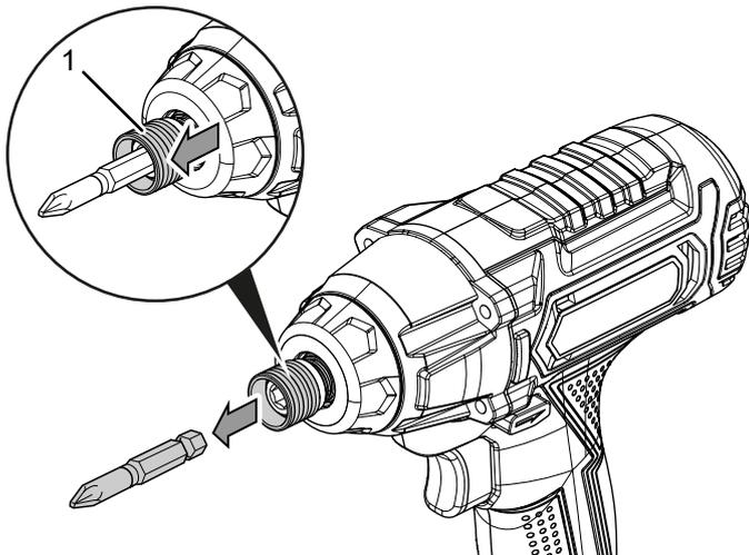
4. Setzen Sie das gewünschte Werkzeug in die Werkzeugaufnahme (1) ein.
