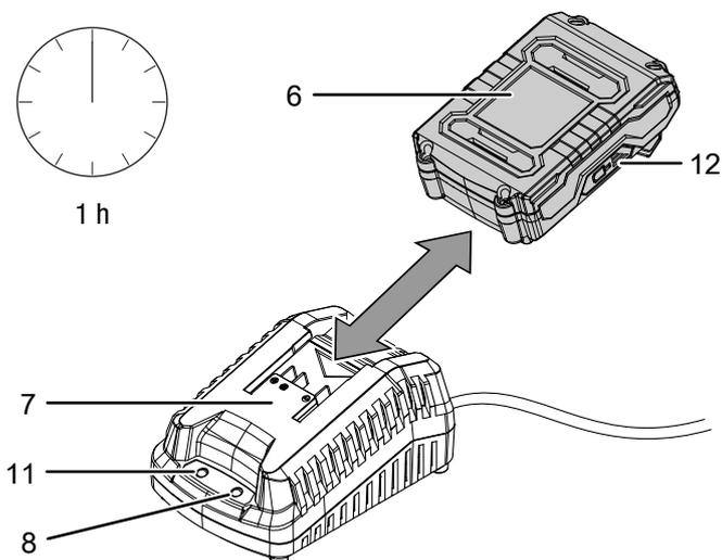
2. Stecken Sie den Netzstecker des Schnellladegerätes (7) in eine ordnungsgemäß abgesicherte Netzsteckdose.
