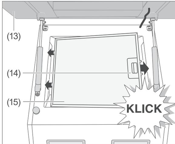
6. Setzen Sie den Fettfilter (15) mit den Zapfen in die Aussparungen.
