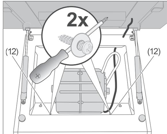
8. Drehen Sie zwei Rundkopfschrauben (12) zum Sichern der Dunstabzugshaube in die vorbereiteten Dübel, und schrauben Sie die Dunstabzugshaube an der Wand fest.
