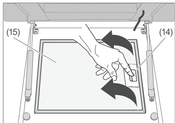
3. Lösen Sie die Verriegelung (14) des Fettfilters (15), und entnehmen Sie den Fettfilter vorsichtig nach unten.
