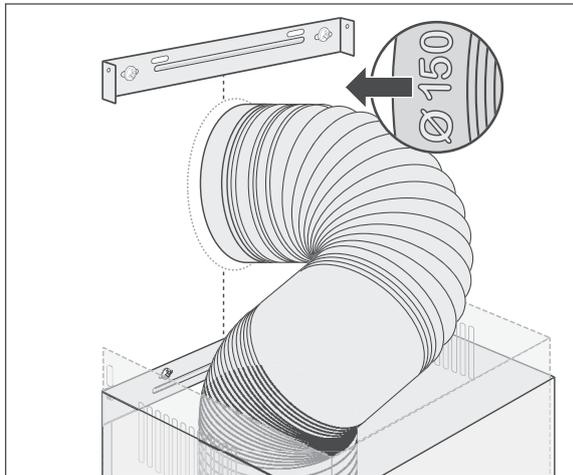
9. Nur bei Abluftbetrieb: Stecken Sie den Abluftschlauch (4) in den Anschluss des Wanddurchbruchs (Schlauchende mit 150 mm Durchmesser).
