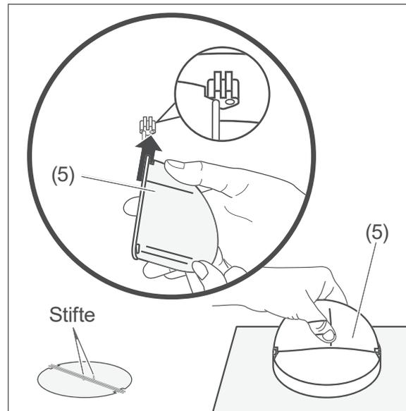
1. Setzen Sie die beiden Hälften der Rückschlagklappe (5) in die Öffnung oben auf die Dunstabzugshaube (1).
