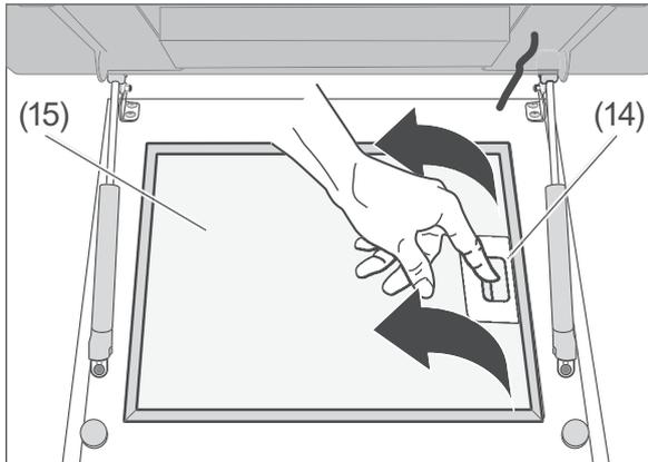
5. Lösen Sie die Verriegelung (14) des Fettfilters (15), und entnehmen Sie den Fettfilter vorsichtig nach unten.
