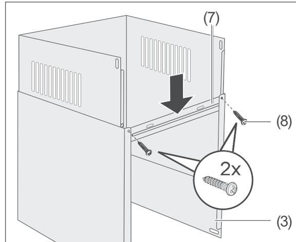
5. Positionieren Sie das Halteblech (7) so an der unteren Kaminblende (3), dass es von innen an den Abkantungen anliegt. (Schrauben- und Langlöcher zeigen nach oben).
