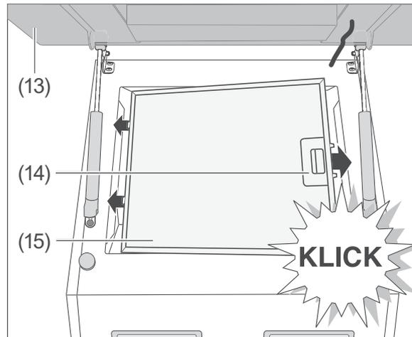
9. Setzen Sie den Fettfilter (15) mit den Zapfen in die Aussparungen.
