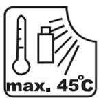
Der Akku darf nicht über längere Zeit starkem Sonnenlicht ausgesetzt werden oder auf einer Heizung liegen (max. 45°C).
