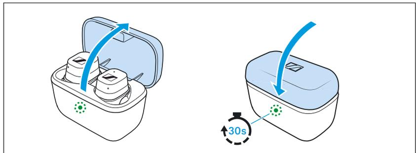
Wenn kein USB-Kabel angeschlossen ist, zeigt die LED-Anzeige der Ladebox den Akku-Ladestand oder den Ladevorgang der Ohrhörer an, wenn Sie den Deckel der Ladebox aufklappen. Wenn Sie den Deckel der Ladebox zuklappen, erlischt die LED-Anzeige nach ca. 30 Sekunden.
