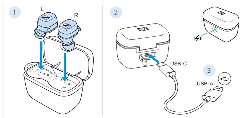
1. Klappen Sie den Deckel der Ladebox über einen leichten magnetischen Widerstand auf und setzen Sie den linken Ohrhörer in das linke und den rechten Ohrhörer in das rechte Ladefach ein. Die Ohrhörer werden magnetisch in das Ladefach gezogen.
