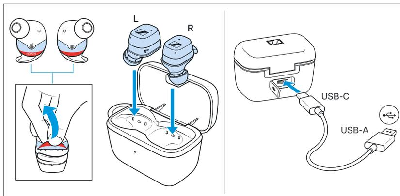
Bei Auslieferung sind die Akkus der Ohrhörer und der Ladebox in einem Schlafmodus und müssen durch einmaliges Anschließen an eine Stromquelle aufgeweckt werden.
