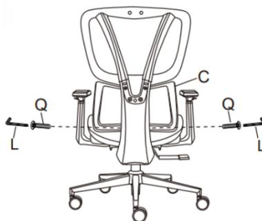
a. Dann befestigen Sie den unteren Teil der Rückenlehne (C) mithilfe von den Schrauben (Q) und dem Schlüssel (L).
