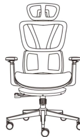
Sie können sich nun bereits auf den fertig montierten Bürostuhl hinsetzen und die Höhenverstellung testen. Setzen Sie sich nun mehrmals auf den Stuhl, damit die Verbindung zwischen Sitz, Gasfeder und Fuß gefestigt wird. Anschließend können Sie die Gasfeder bedienen und die Stuhlhöhe individuell einstellen.
