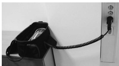
Das Prüfgerät kann auch in der gepolsterten Tasche getragen und liegend verwendet werden. Die Tragetasche besitzt eine Öffnung zur Durchführung der Prüflleitung.
