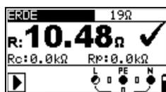
Abbildung 5.35: Beispiel Erdungswiderstandsmessung
