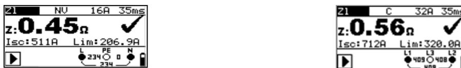
Abbildung 5.29: Beispiel Leitungsimpedanzmessung
