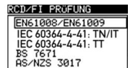
Abbildung 4.5: Auswahl der FI/RCD-Norm
