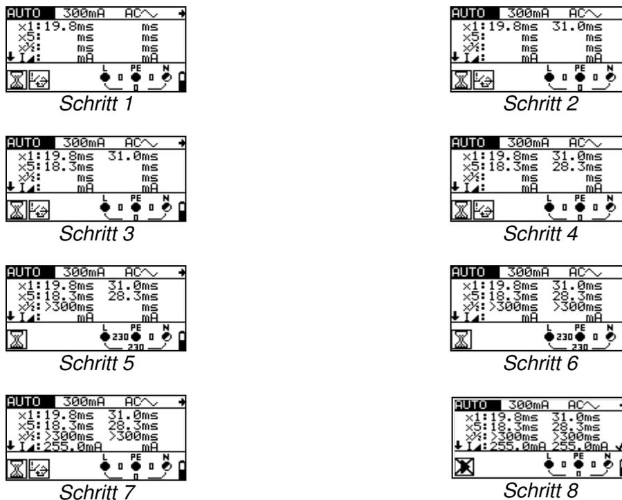
Abbildung 5.21: Prüfschritte der Automatikprüfung
