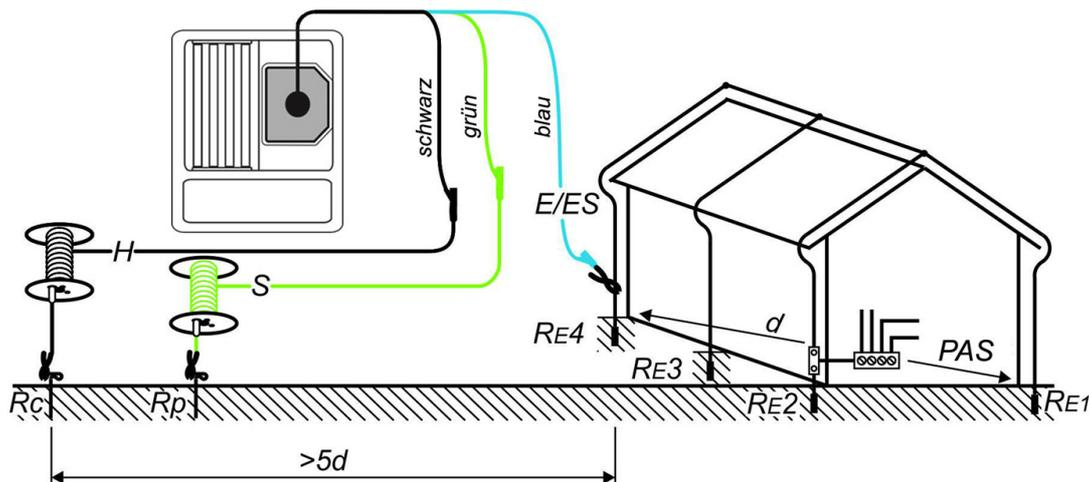
Abbildung 5.34: Anschluss des optionalen Erdungssets (044113) - Messung am Blitzableiter
