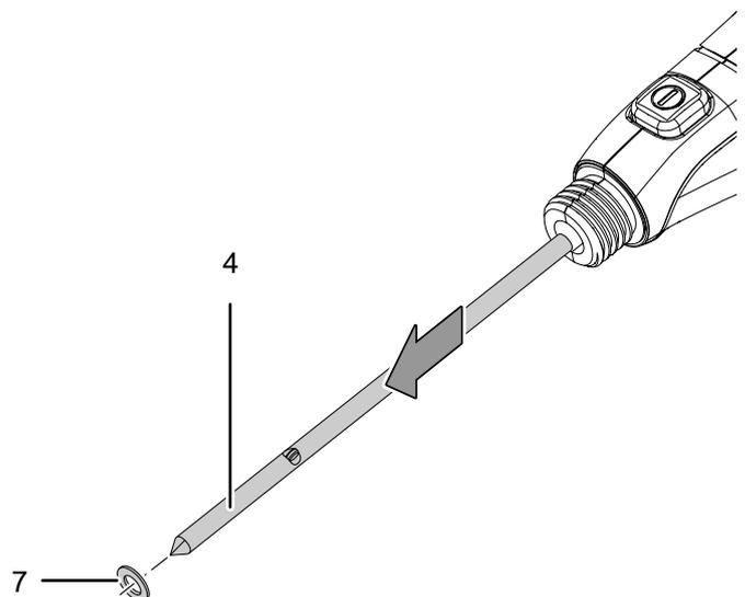
4. Entfernen Sie die Unterlegscheibe (7) von der Graverspitze.
