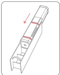
Schieben Sie den Lichtstab in das Lichtrichtungs kontrollraster und sichern Sie ihn mit den Gummibändern.
