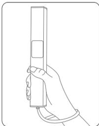
② Schrauben Sie das Verbindungsstück des Schlüsselbands in das 1/4"-Gewindeloch an der Unterseite des Lichtstabs, um es für den Handgebrauch an Ihrem Handgelenk zu befestigen.
