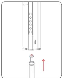
Richten Sie die 1/4-Zoll-Schraube des Lichtstativs mit dem 1/4-Zoll-Gewindeloch an der Unterseite des Lichtstabs aus. Drehen Sie den Lichtstab um ihn am Lichtstativ zu montieren.
