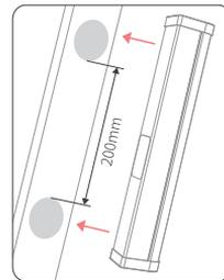
② Kleben Sie das mitgelieferte Blech mit einem Kleber auf einen Nichtmetallischen Gegenstand an und befestigen Sie die Leuchte anschließend mit dem Magneten.
