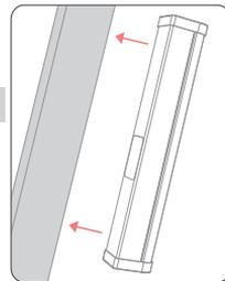
① Durch den integrierten Magneten lässt sich die Leuchte direkt an jeder Metalloberfläche befestigen.
