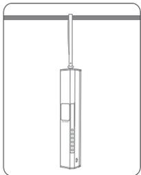
① Schrauben Sie das Verbindungsstück des Schlüsselbands in das 1/4"-Schraubloch oben am Lichtstab, um es an der Querstange eines Ständers aufzuhängen.
