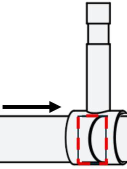
**!Bei Gardinenstangen ab 2,10m muss an der Trennstelle der Rohre ein zusätzlicher Träger angebracht werden!**
