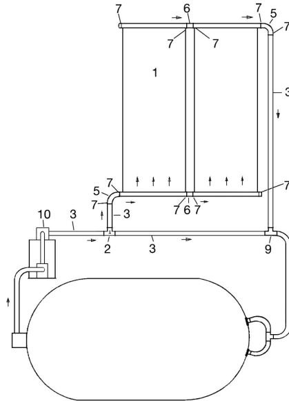
Beispiel einer Anbindung mit dem 2-Wege Ventil mit Stellantrieb (automatische Bedienung mit elektrischer Steuerung).
