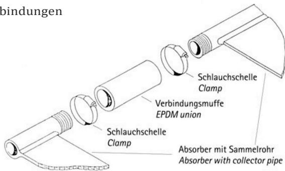
Aus strömungstechnischen Gründen ist eine Wasserfließgeschwindigkeit größer als 1 m/s zu vermeiden. Deshalb dürfen keine Absorbergruppen mit mehr als  $45 \text{ m}^2$  gebildet werden.
