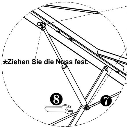
Stellen Sie beim Montieren sicher, dass sich beide Enden der Stange in derselben Ebene befinden, und ziehen Sie dann die Anti-Skid-Nuss fest. Wenn die Stange stecken bleibt, drehen Sie das Werkzeug, um das Problem unter der Stange zu lösen.
