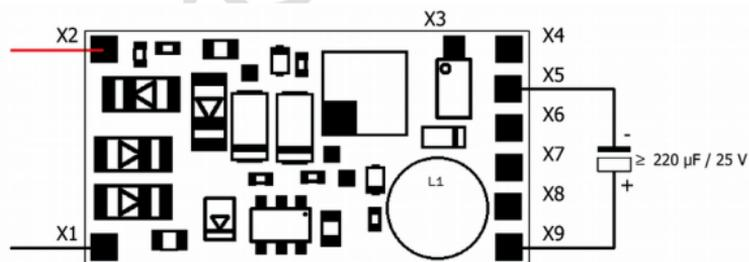
Fig. 5: Anschluss eines Stützkelkos
