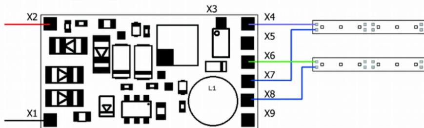
Fig. 2: Anschluss von LED-Streifen
