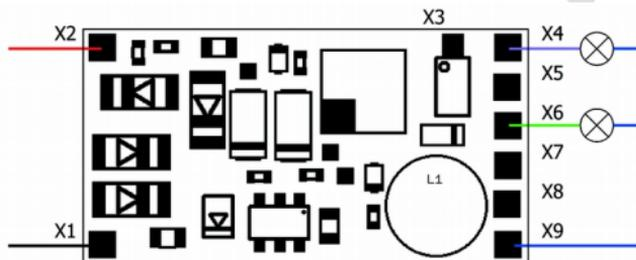
Fig. 3: Anschluss beliebiger Verbraucher an die verstärkten Ausgänge
