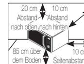
1. Achten Sie beim Aufstellen des Geräts auf ausreichende Belüftung. Hinter dem Gerät und an den Seiten sollten mindestens 10 cm und oberhalb des Geräts mindestens 20 cm Abstand eingehalten werden.
