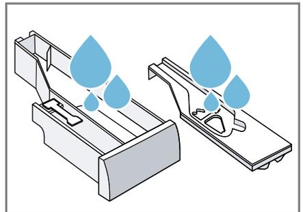
9. Die Waschmittelschublade, den Deckel und die Pumpeneinheit abtrocknen und einsetzen.
