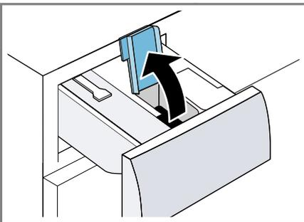
3. Flüssigwaschmittel  $\text{O}$  und Weichspüler  $\text{O}$  in die entsprechenden Dosierbehälter füllen.
