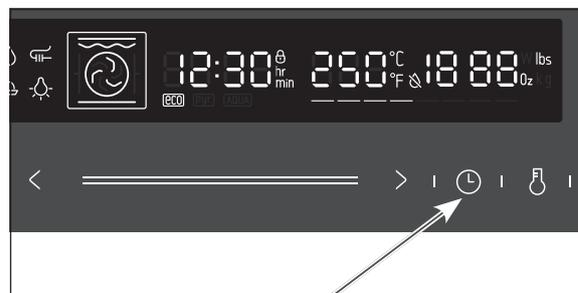
1. Tippen Sie auf den Sensor . Im Display blinken die beiden Nullen für die Stundenanzeige.
