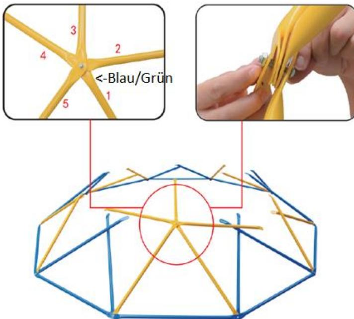
Nun werden neben dem Teil, welches soeben montiert wurde 2 neue Bronze Stangen, 1 blaue/grüne Stange und zwei Bronze Stangen zusammengesetzt. Ziehen Sie anschließend die Schrauben mit Teil I und Teil J an.
