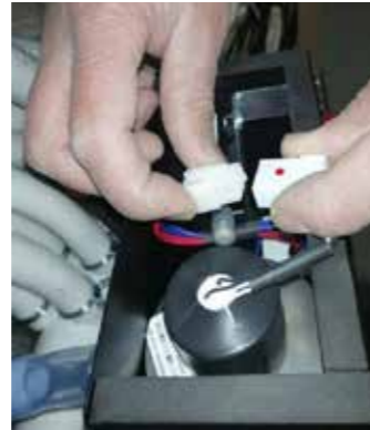
3. Schritt: Weiße Verbindungsstücke entkuppeln
