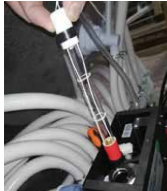
5. Schritt: UV Licht zum Wechseln rausnehmen
