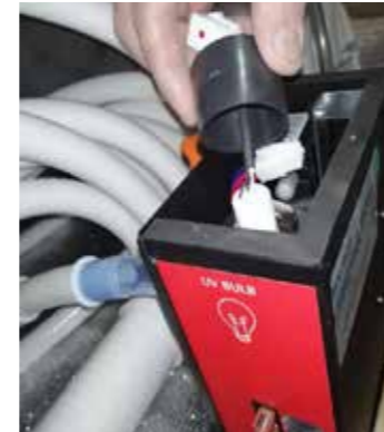
4. Schritt: Schwarze Abdeckung herausnehmen
