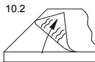
T10 Bei Hochglanz-Fronten bitte erst die Schutzfolie entfernen und dann den Griff montieren!
