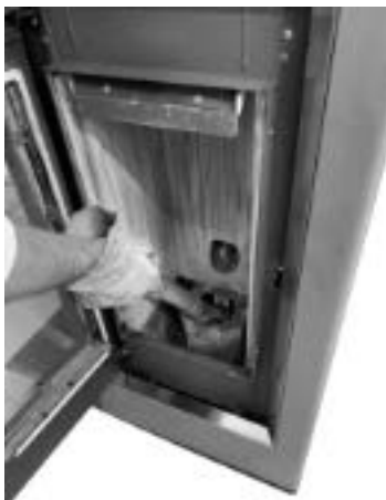
Fig. 35 - Reinigung Fach Brennschale
