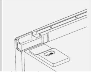
32. Verbindungskabel in die Kabelführung der Abdeckung legen.
