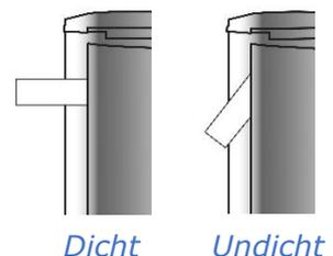
2. Eine Taschenlampe auf eine Glasablage im Gerät stellen, Lichtschein in Richtung der Gerätetürdichtung ausrichten und Tür schließen. Scheint kein direktes Licht durch, ist die Gerätetürdichtung dicht.
