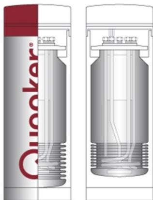
Denn dieses Reservoir hat Platz für Expansionswasser, weil die Kesselwand aus Edelstahl flexibel ist. Ein Teil des Reservoirs ist als **Balg** konzipiert, der sich bei jedem Aufheizen des Wassers etwas ausdehnen kann. Sobald Wasser abgezapft wird, schrumpft der Balg in seine Ausgangsposition zurück und ist wieder bereit, frisches Leitungswasser aufzuheizen.
