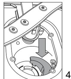
Setzen Sie die Filtereinheit nach der Reinigung der Filtersiebe wieder korrekt in ihren Sitz ein, dies ist äußerst wichtig, um eine ordnungsgemäße Betriebsweise des Geschirrspülers zu gewährleisten.
