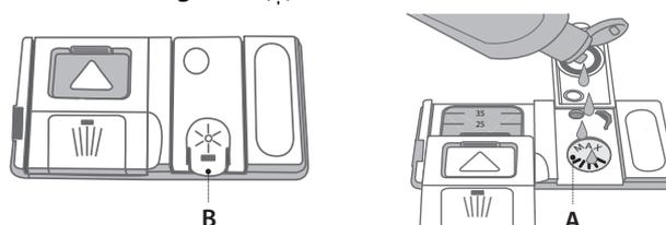
1. Den Behälter **B** durch Drücken und Anheben der Zunge am Deckel öffnen.
