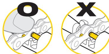
Drücken Sie die Kette nieder, um sie stabil in der Kettenführung zu halten, wenn Sie den Kettennietstift herausdrücken. Achten Sie darauf, dass die Kettennietstiftspindel des Kettennieters zentral auf den Kettennietstift drückt um eine Beschädigung des Kettennieters bzw. der Kette zu vermeiden.
