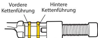
Verwenden Sie die vordere Kettenführung zum Einsetzen und Entfernen des Kettennietstifts. Verwenden Sie die hintere Kettenführung, um schwergängige Kettenglieder zu lösen.
