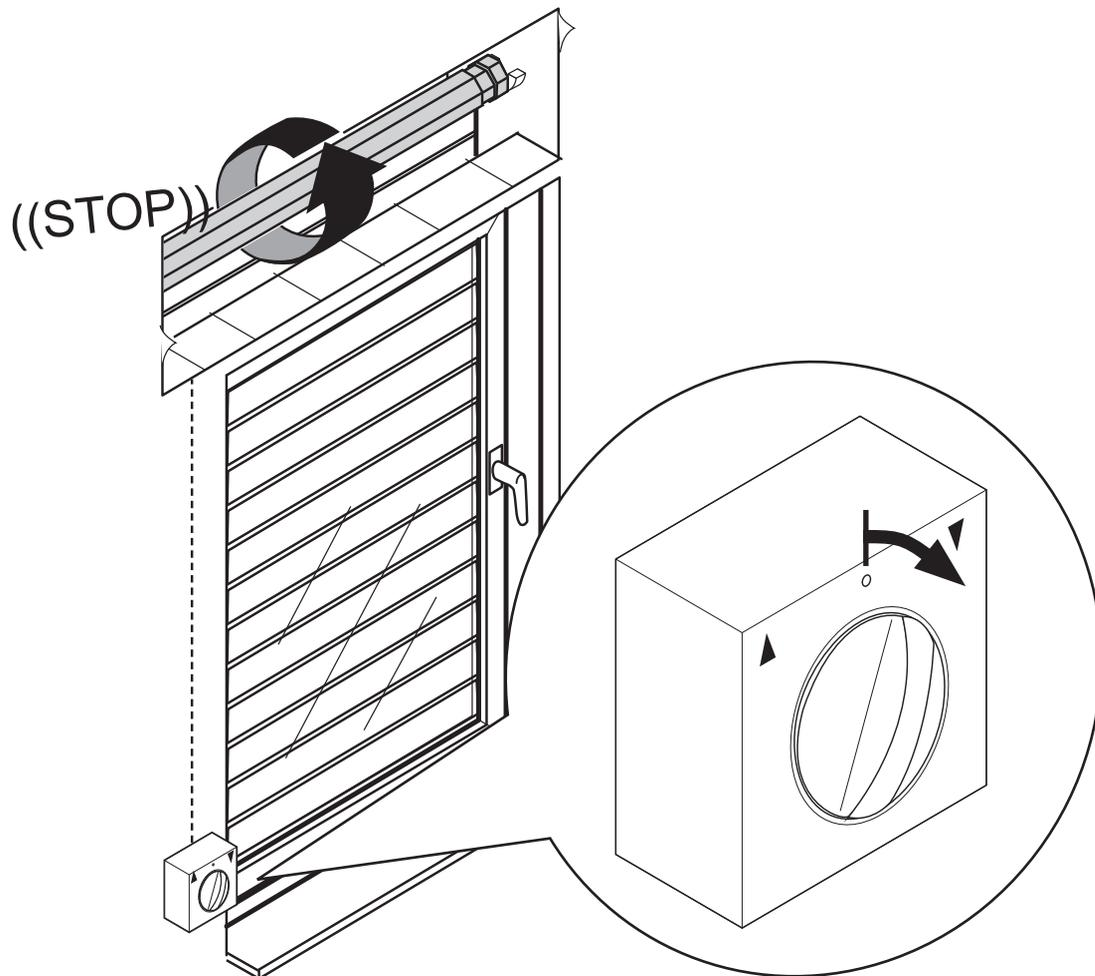
Fahren Sie den Rohrmotor so lange in Richtung AB (▼) bis der Rohrmotor stoppt.
