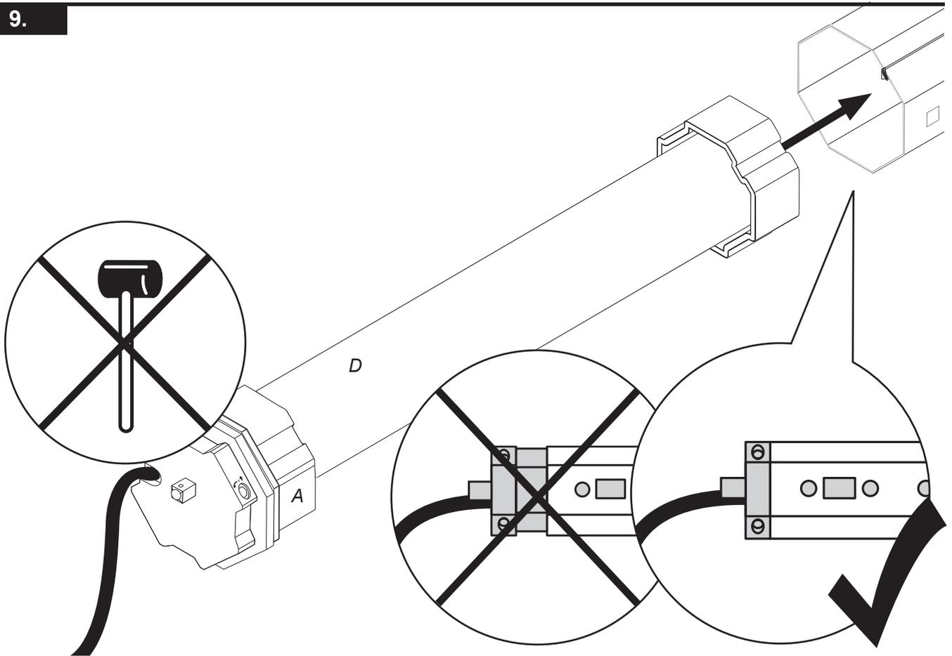
Der Rolladenmotor (D) und Laufring (A) müssen bis zum Anschlag in der Welle stecken.
