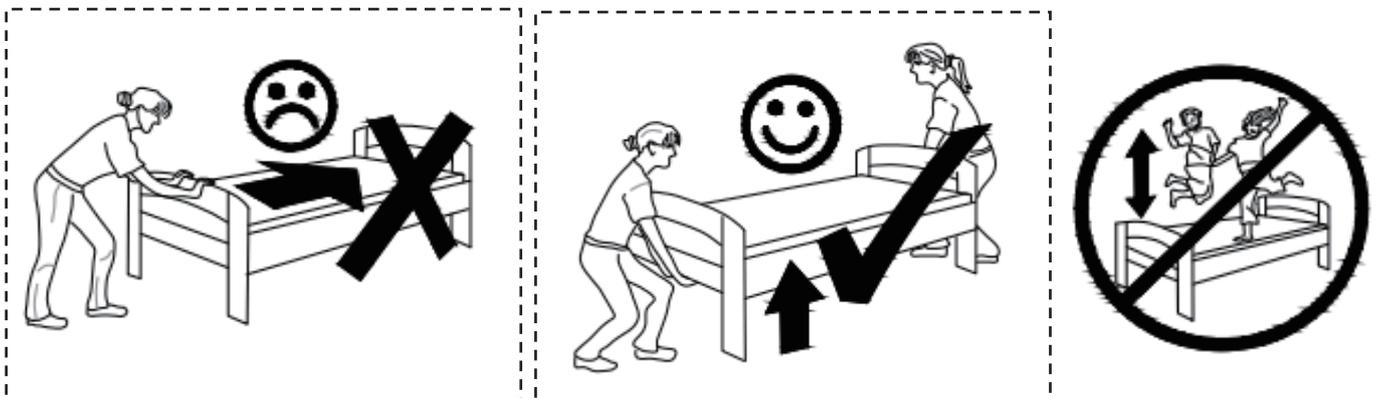
Vor dem Einbau die Schrauben in die Löcher stecken und festziehen, aber nicht bis 100%, 70% bis 80% anziehen reicht aus. Schließlich, nachdem alle Schrauben installiert sind, ziehen Sie alle Schrauben auf 100%. Wenn Sie auf diese Probleme stoßen, wie z. B. Fehlausrichtung der Löcher oder Unfähigkeit, bestimmte Teile zu installieren, überprüfen Sie bitte, ob die Schrauben korrekt verwendet werden und passen Sie die Dichtigkeit der Schrauben an.
