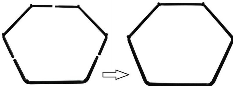
2. Leg de springmat (TR03) op de grond met de haken omhoog. Plaats het frame in het midden van de springmat. (Zorg ervoor dat de beugels op de poten ook naar boven wijzen). Verbind nu via lussen de elastiek (TR04) met de haken van de springmat en het frame. Wissel altijd met de tegenoverliggende kant.
