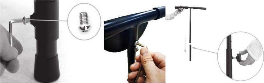
9. Verbinden Sie die T-Griffstange (TR05) und die verstellbare Stange (TR06) mit den Schrauben (TR13).
