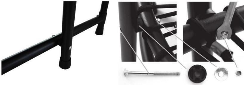
8. Fixez le raccord (TR08) avec les vis (TR13).
