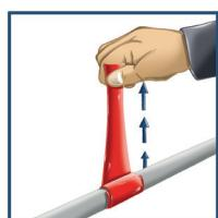
4. La cinta debe ser constantemente muy estirada hasta aprox. 200% y enrollada bajo presión y superposición. Asegúrese de que la cinta se superpone al menos el 50% del ancho (autofusión).
