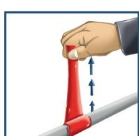
4. Span de tape voortdurend op tot ca. 200% en wikkel hem op onder spanning en overlappend. Zorg ervoor dat de tape minstens 50% van de breedte overlapt (zelfdichtend).
