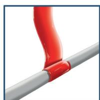
3. Aplique la cinta y sujetela con el pulgar. Estire la cinta y al enrollar la primera vuelta la cinta tiene que solaparse completamente (la posición de la cinta está sujetada para continuar a enrollarla).
