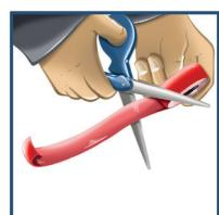
1. Önce işlem yapılacak yüzeyi veya tamir edilecek ürünü temizleyin. Bant rulosundan gerekli uzunlukta bant kesin.
