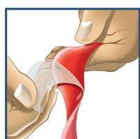
2. Retire la cubierta protectora transparente del lado superior de la cinta y coloque la cinta sobre el elemento a reparar.
