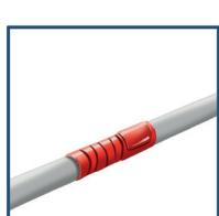
5. Span de laatste omwikkeling minder hard op. Zorg ervoor dat de tape zichzelf volledig overlapt. Druk 10 seconden op de tape tot hij vastzit.
