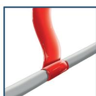
3. Posez le ruban adhésif, fixez-le avec votre pouce. Étirez le ruban et rembobinez le premier enroulement en le faisant se chevaucher complètement (Pour les prochains enroulements, plus besoin de le fixez).
