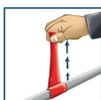
4. Étirez la bande en permanence à environ 200 % et enroulez-la sous tension et en la superposant. Assurez-vous que le ruban chevauche au moins 50 % de la largeur (auto-soudage).
