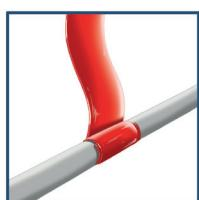
3. Legen Sie das Band an, fixieren Sie es mit dem Daumen. Dehnen Sie das Band und umwickeln Sie die erste Umlaufung komplett überlappend (Position des Bandes ist für weitere Umlauungen fixiert).
