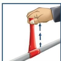
4. Überdehnen Sie das Band konstant auf ca. 200% und wickeln Sie es unter Spannung und überlappend auf. Stellen Sie dabei sicher, dass das Band zu min. 50% der Breite überlappt (Selbstverschweißung).
