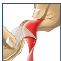
2. Następnie należy ściągnąć folię i przyłożyć taśmę do elementu, na który ma zostać nawinięta.
