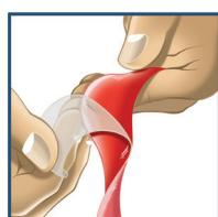
2. Retirez le film au-dessus de la bande et placez la bande sur l'objet à réparer.
