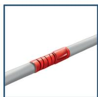
5. Estire menos la última vuelta, comprobando que la cinta esté completamente solapada. Presione la cinta durante 10 segundos hasta que esté firmemente soldada.
