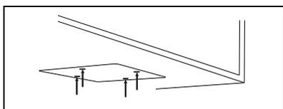
4. Schrauben Sie die Montageplatte mit den **kurzen** Schrauben fest.
