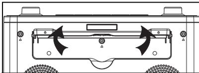
1. Klappen Sie den Standfuß auf der Geräte-Unterseite vollständig heraus.
