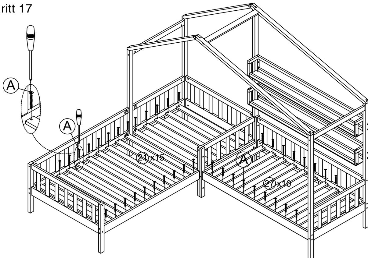
Befestigen Sie zunächst 2 Stück von Teil 21 und von Teil 27 an der Vorderseite und am Ende des Rahmens zwischen dem Kopfteil.
