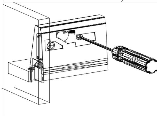
**Mit Betätigung der vorderen Schraube wird die Fronteinstellung in horizontaler Richtung vorgenommen!**
