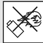
Werfen Sie den Akku nicht in den Hausmüll, ins Feuer oder ins Wasser. Setzen Sie den Akku nicht über längere Zeit starker Sonneneinstrahlung aus und legen Sie ihn nicht auf Heizkörpern ab (max. 45 °C).
