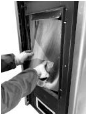
Fig. 79 - Die Rückseite des Feuerraums entfernen
