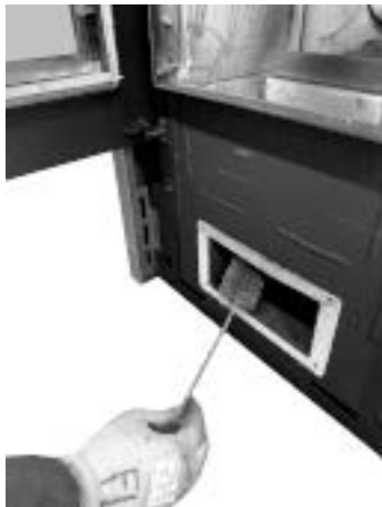
Fig. 73 - Mit einer Rohrreinigungsbürste reinigen
