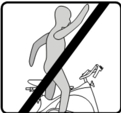
Die Masse der Schwingscheibe dieses dynamischen Trainingsgerätes ist sehr hoch. Steigen Sie nicht vom Gerät ab, während sich die Schwingscheibe noch dreht. Andernfalls besteht Schleudergefahr und Verletzungen können verursacht werden.
