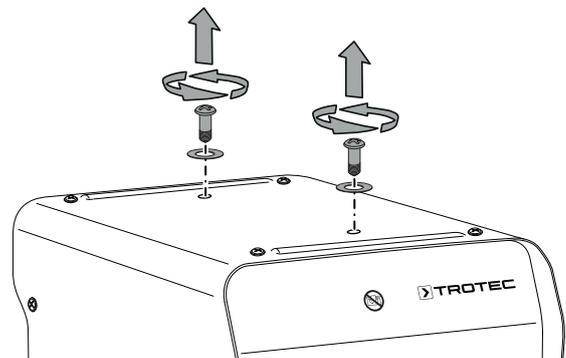
2. Montieren Sie den Transportgriff mit den Schrauben und Unterlegscheiben.
