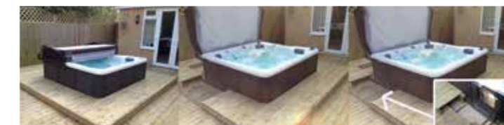
Stellen Sie sicher, dass ein Teil Ihrer Terrasse entfernt werden kann, um Zugang für zukünftige Reparaturen oder Wartungsarbeiten zu erhalten.
