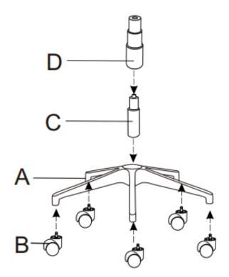
Drücken Sie die Rollen (**B**) in die fünf Öffnungen des Fußkreuzes (**A**).
