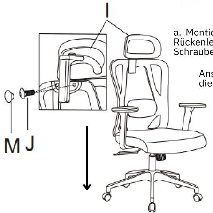
a. Montieren Sie die Kopfstütze (**I**) an der Rückenlehne mit den dafür vorgesehenen Schrauben (**J**).
