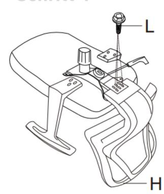
Befestigen Sie die Rückenlehne (**H**) am unteren Teil der Sitzfläche, und zwar an der Mechanik (**E**) mit den dafür vorgesehenen Schrauben (**L**).
