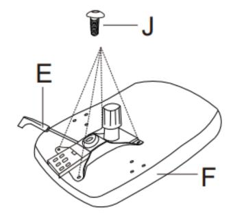
Befestigen Sie die Mechanik (**E**) am unteren Teil der Sitzfläche (**F**) mit den Schrauben (**J**).
