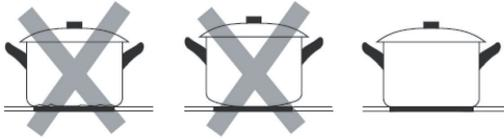
Le pentole realizzate con i seguenti materiali non sono adatte: acciaio inossidabile puro, alluminio o rame senza fondo magnetico, vetro, legno, porcellana, ceramica e terracotta. Non utilizzare pentole con bordi affilati o con la parte inferiore arrotondata.
