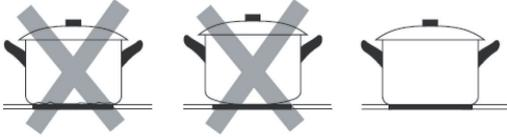
La batería de cocina que esté fabricada en los siguientes materiales no podrá utilizarse: acero inoxidable puro, aluminio o cobre sin fondo magnético, cristal, madera, porcelana, cerámica o latón. No utilice ningún recipiente con cantos afilados ni que presente un fondo abombado.
