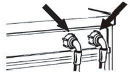
**10** Schrauben Sie mit der Hand den Zulaufschlauch am Wasserhahn an und ziehen Sie die Mutter an.
