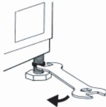
6. Heben Sie die Maschine leicht an und stellen Sie die Höhe des Fußes durch Drehen ein.
