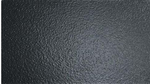
1. 1 satter Spritzgang aus 90 cm Entfernung, Spraydose dabei langsam führen und Lackmaterial gleichmäßig in überlappenden Spritzgängen applizieren, bis ein geschlossener Lackfilm vorliegt
