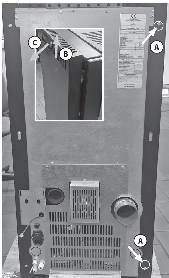
La partie inférieure du côté gauche de l'appareil est maintenant dégagée et on a accès au boîtier du **ventilateur d'extraction (28)**.
