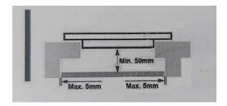
An der Außenseite des Kochfeldes befinden sich Lüftungsöffnungen. Sie MÜSSEN sicherstellen, dass diese Öffnungen nicht durch die Arbeitsplatte blockiert werden, wenn Sie das Kochfeld in Position bringen. Beachten Sie, dass der Klebstoff, der das Kunststoff- oder Holzmaterial mit den Möbeln verbindet, einer Temperatur von nicht unter 150°C standhalten muss, um ein Ablösen der Verkleidung zu vermeiden.
