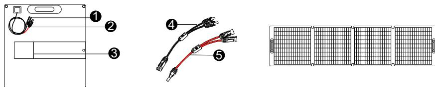
1. das Solaranschlusskabel- 3. die Halterung für das Solarmodul 5. MC4 Plus-Parallelkabel
