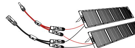
5. das Ausgangskabel des Solarmoduls wird mit dem MC4-Adapterkabel verbunden, um das Kraftwerk aufzuladen.
