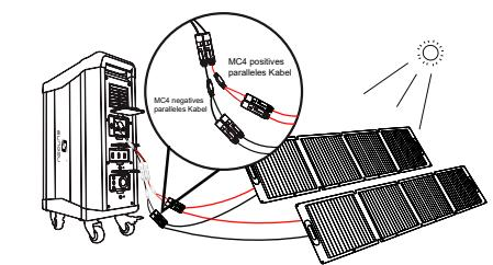
6. zwei oder mehr MC4 parallele Kabelanschlussmethode (gleiche Anschlussmethode für beide MC4 positive parallele Kabel & MC4 negative parallele Kabel)
