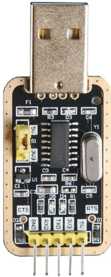
Da dieses USB-TTL Interface auf dem weitverbreitetem CH340G Chip basiert, ist dieses Interface in der Regel ohne zusätzliche Treiberinstallation betriebsbereit. Zusätzlich kann durch die Konfiguration mit Steckbrücken zwischen 3,3V und 5V (sowohl Versorgungsspannung als auch Logiklevel) umgeschaltet werden.
