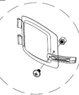
Tür (8) mittels des Splintes (E) am Scharnier (11) gemäß der Zeichnung, sichern Sie den Splint mit dem Federsplint (D).
