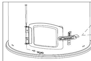
montieren Sie den Türriegel mittels dem Schraubenset M4X10MM.
