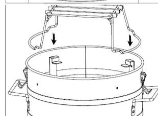
Montieren Sie die Verriegelungsspannen (5) und die Verriegelungshaken (4) am Oberteil des Korpus (7) mittels des Schraubenset M4X10MM. Wiederholen Sie diesen Schritte für alle Verriegelungen.
