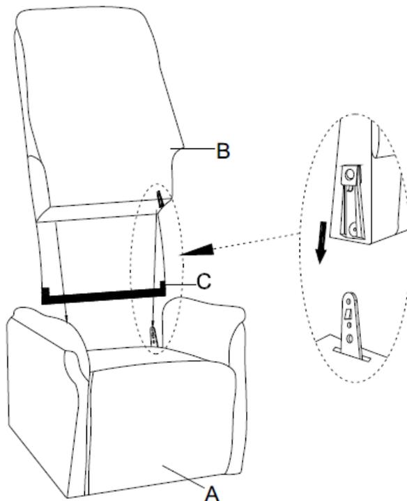
1. Die Rückenlehne (B) wie auf dem Bild ersichtlich in die Aufnahme stecken
