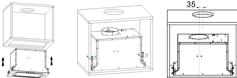
Schieben Sie die Dunstabzugshaube in das Schrankgehäuse. Ziehen Sie die Schrauben von der Oberseite her fest. Hinweis für das Auslassloch im Schrankgehäuse: Der Luftauslass oben an der Abzugshaube ist um 35 mm versetzt, gemessen von der Mitte der Abzugshaube.
