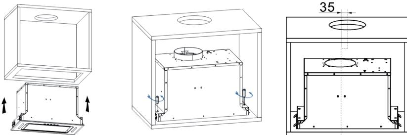
Deslice la campana de la cocina en el alojamiento del gabinete. Apriete los tornillos desde arriba. Nota para el agujero de salida del armario: La salida de aire en la parte superior de la campana extractora está compensada por 35 mm, medidos desde el centro de la campana.
