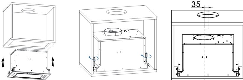
Far scorrere la cappa nell'alloggiamento dell'armadio. Serrare le viti dall'alto. Nota per il foro di uscita nel mobile: L'uscita dell'aria nella parte superiore della cappa è sfalsata di 35 mm, misurata dal centro della cappa.
